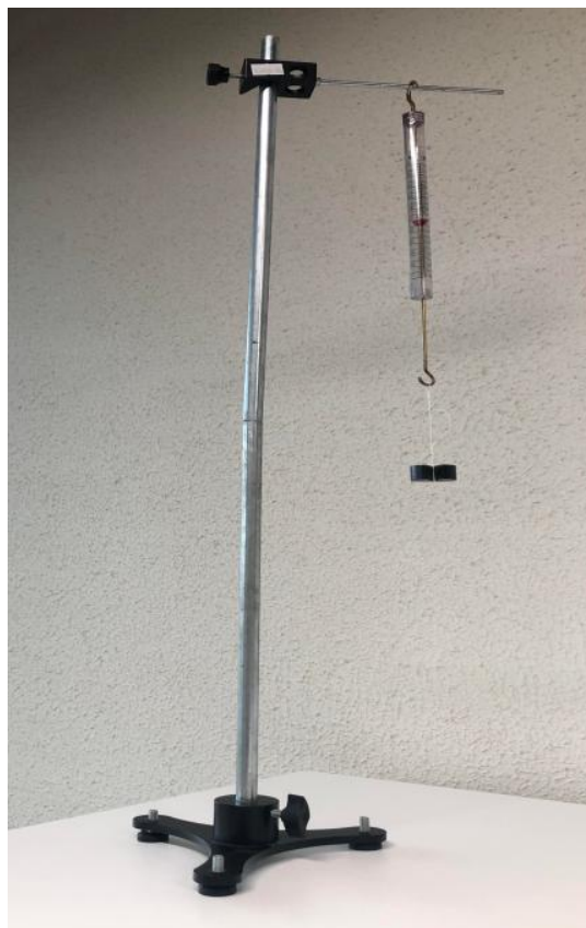
Figura 1: Montagem para oscilador elástico de uma mola desconhecida. Fonte: autores.
